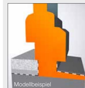
Die **MITTLERE** Abdichtung zwischen Fensterrahmen und Mauer muss vollständig mit wärmedämmendem Material ausgefüllt werden. Sie garantiert den nötigen Wärme- und Schallschutz.
