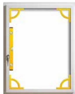
Der verschweißte Flügelrahmen wird winkelig gespannt.
